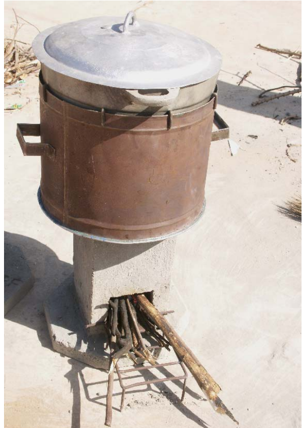
Illustration 21: Joint entre le conduit et la chambre de combustion (détail)
