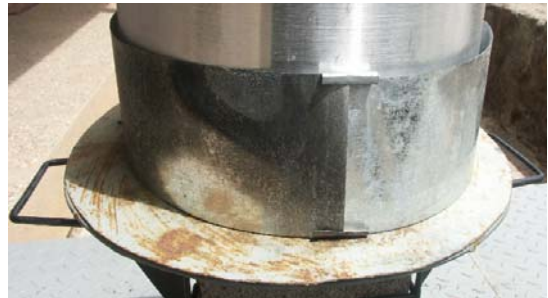
Illustration 16: Manchette en tôle selon le prototype HEPNR
