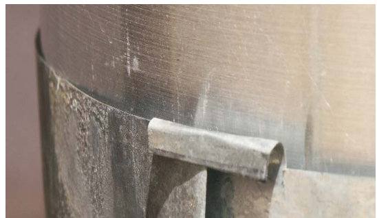
Illustration 17: Exposition à des risques de blessures avec la manchette en tôle du prototype HEPNR
