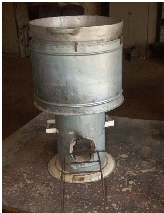
Illustration 3: Foyer Rocket pour marmite de 4 -7 kg
