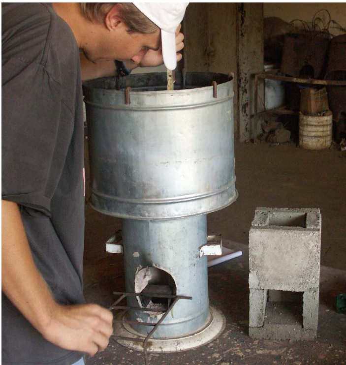
Illustration 6: Comparaison de la taille du foyer Rocket pour marmite 4 – 7 kg avec le prototype éthiopien
