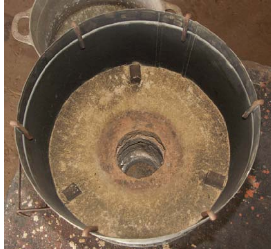
Illustration 15: Conduit du foyer Rocket vu d'en haut (prototype Sénégal)
